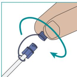
Figure 2-3 Retrait du capuchon de connecteur cannelé transitoire/
