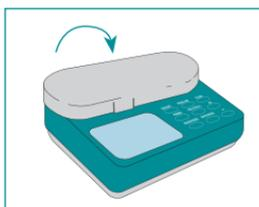
Figure 2-9 Fermeture de la porte de la pompe
