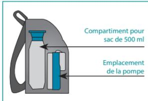
Figure 6-8 Super mini sac à dos (vue en coupe de compartiments internes)
