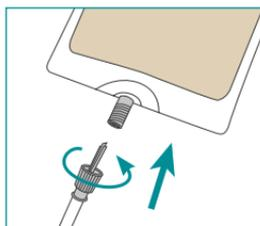
Figure 2-1 Vissage de la pointe sur le contenant
