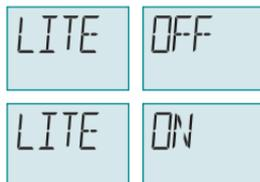
Figure 2-32 Réglages du rétroéclairage LITE OFF (éclairage éteint) et LITE ON (éclairage allumé)
