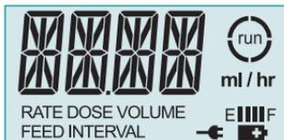
Figure 1-4 Segments de l'afficheur
