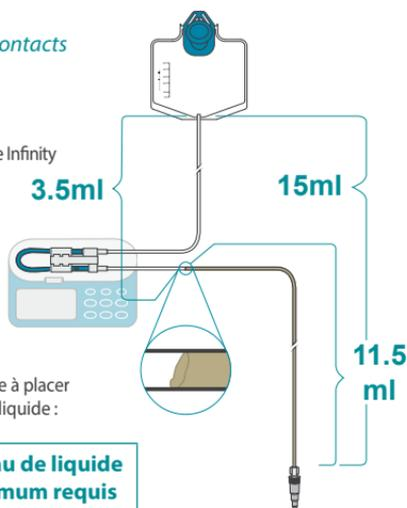
Figure 9-1 Fluide résiduel dans la trousse jetable
