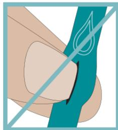
Figure 2-7 Segment de tubulure perforé par un ongle
