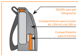
Imagen 6-13: Mochila (corte transversal de los compartimientos internos)
