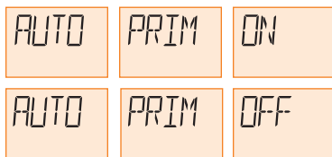
Figure 2-27 Configuraciones de autocebado AUTO PRIM ON (autocebado encendido) y AUTO PRIM OFF (autocebado apagado)
