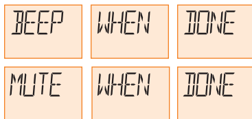
Imagen 2-23: Configuraciones de la dosis finalizada; BEEP WHEN DONE (Sonar al finalizar) y MUTE WHEN DONE (Silenciar al finalizar)
